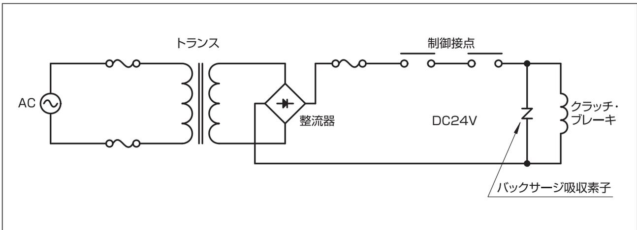
バックサージによるアーク熱で、空气中的窒素が固定され、硝酸が合成されることがあります。接点近傍の緑色の付着物は、この硝酸と接点の銅が化合した生成物で、接点の負荷が重すぎる兆候です。このような場合は、接点の寿命が極端に短いと推定できますので、接点を直列接続したり、より能力の大きい接点を使うようにしてください。
