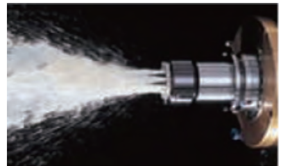
センタースルーによって、切削液がコレットと刃先より吐出するタイプ。
