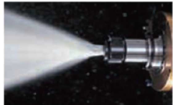
センタースルーによって、切削液がホルダと刃先の隙間より吐出するタイプ。
