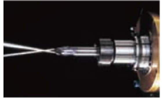
センタースルーによって、切削液が刃先より吐出するタイプ。
