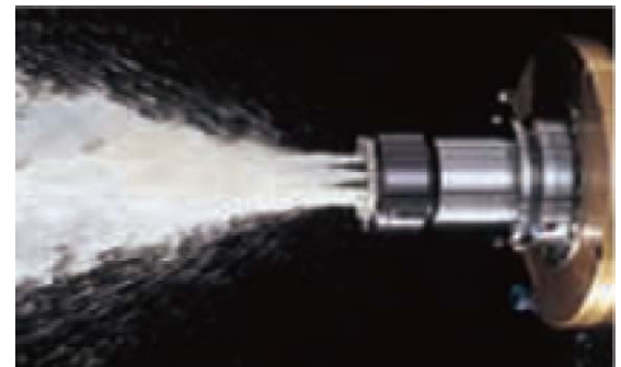
センタースルーによって、切削液がコレットと刃先より吐出するタイプ。
