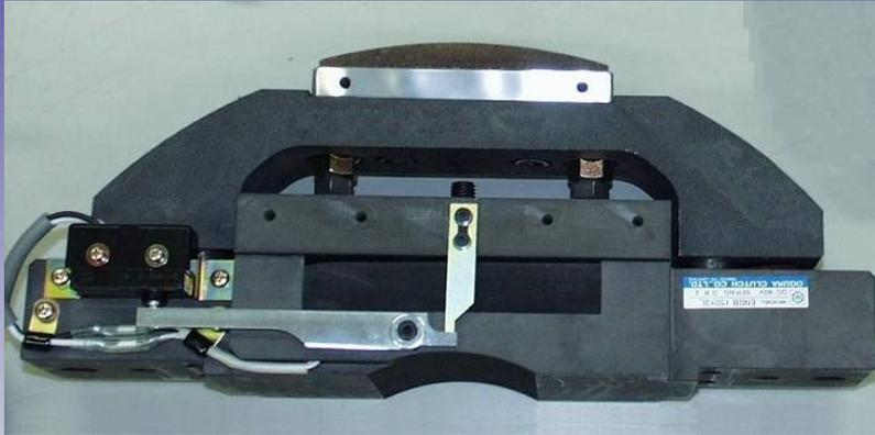
ビル用エレベーターの動力機械のブレーキとして働き、エレベーターを保持・非常時制動させています。
