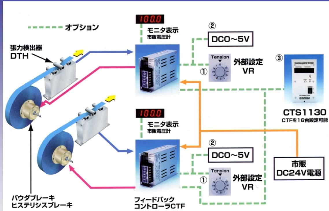
糸やテープを送る場合に、これらが弛んだり、切れたりしないよう一定の張力を掛けてコントロールする役目をします。使用例として炭素繊維製造装置や半導体製造装置などに使用されています。
