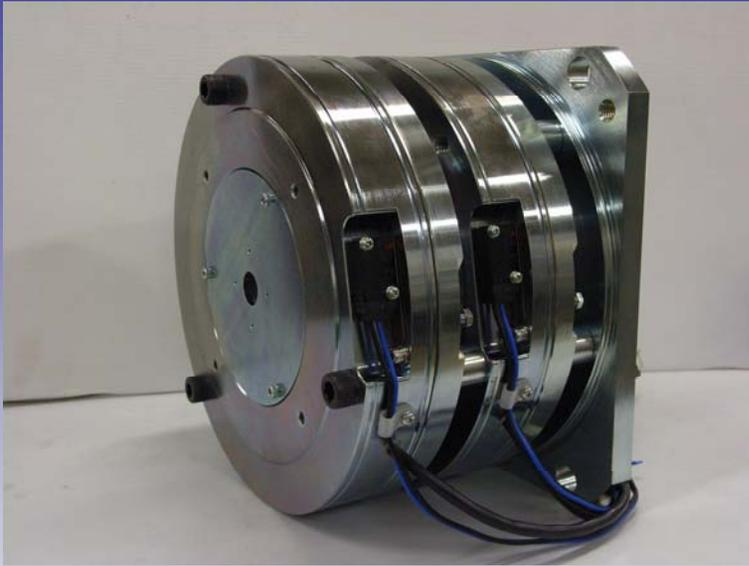
新規制法に適應したビル用エレベーターの動力機械のブレーキとして働き、エレベーターを保持・非常時制動させています。
